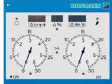
Диапазоны измерений для обеих версий составляют 0-8 / 0- 40 кН. При испытании легкового автомобиля стенд автоматически переключается на 8 кН.
