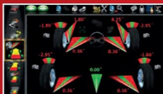
Простой доступ к трудно доступным точкам регулировки (при повёрнутых колёсах; показания схождения такие же, как при их прямом положении)
