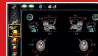
Измерения предназначены для расширенного поиска неисправностей обычных и модифицированных подвесок, и включают ввод высоты шасси, ProAckermann, график изменения кастера, радиус обкатки и суммарный угол.
