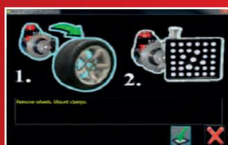
Для легкого доступа к местам регулировки снимите колёса, и закрепите мишени на тормозных дисках.
